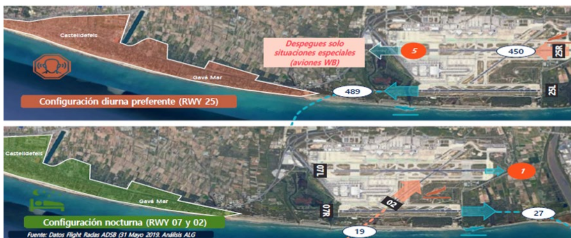
Figura 9. Configuració operacional actual diürna i nocturna. Font Flight Radar – ADSB. Joan Rojas
