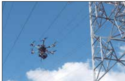
El dron d'Endesa comprovant l'estat de la xarxa elèctrica. FOTO: ENDESA
